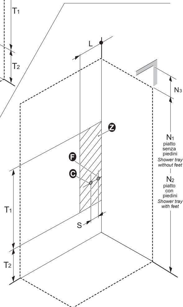
**Installazione attacchi acqua calda e fredda per cabina versione DESTRA.**
