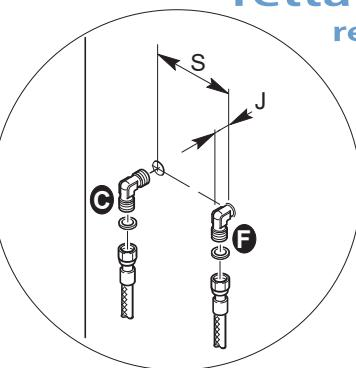
**Installazione attacchi acqua calda e fredda per cabina versione SINISTRA.**
