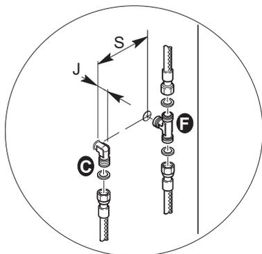
**Installazione attacchi acqua calda e fredda per cabina versione DESTRA.**
