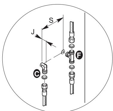
Installazione attacchi acqua calda e fredda per cabina versione DESTRA.
