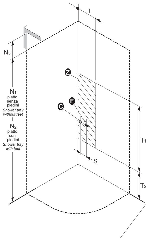
**Installazione attacchi acqua calda e fredda per cabina versione SINISTRA.**
