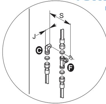
**Installazione attacchi acqua calda e fredda per cabina versione SINISTRA.**
