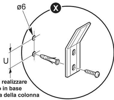
\* Forature fissaggi da realizzare in fase di montaggio in base all'altezza desiderata della colonna
