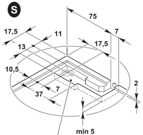
**Il pozzetto di scarico
